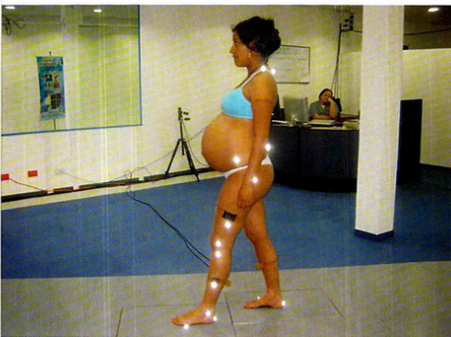
Las esferas reflectivas permiten obtener información precisa sobre el movimiento.
