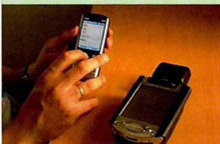
● Prototipo del equipo de guiado por satélite para invidentes.
