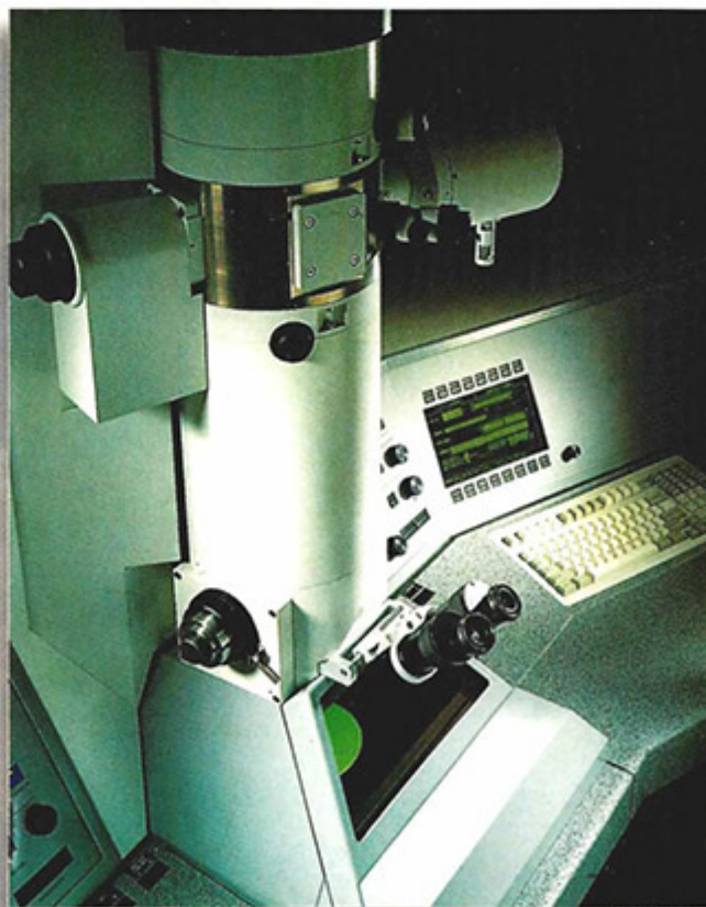
Figura 4. Microscopio electrónico moderno de transmisión. (Tomado de LEO).
