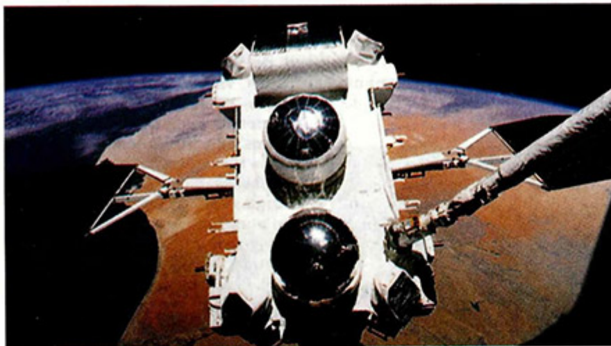
Figura 3. El Observatorio Compton de Rayos Gamma, un satélite de dieciséis toneladas de peso puesto en órbita por el transbordador espacial en 1991 y diseñado para detectar fuentes de rayos gamma. Está a una altura de 400 km sobre la superficie terrestre y le da una vuelta a la Tierra cada noventa minutos. En promedio, cada día detecta una explosión de rayos gamma. (foto cortesía de NASA).
