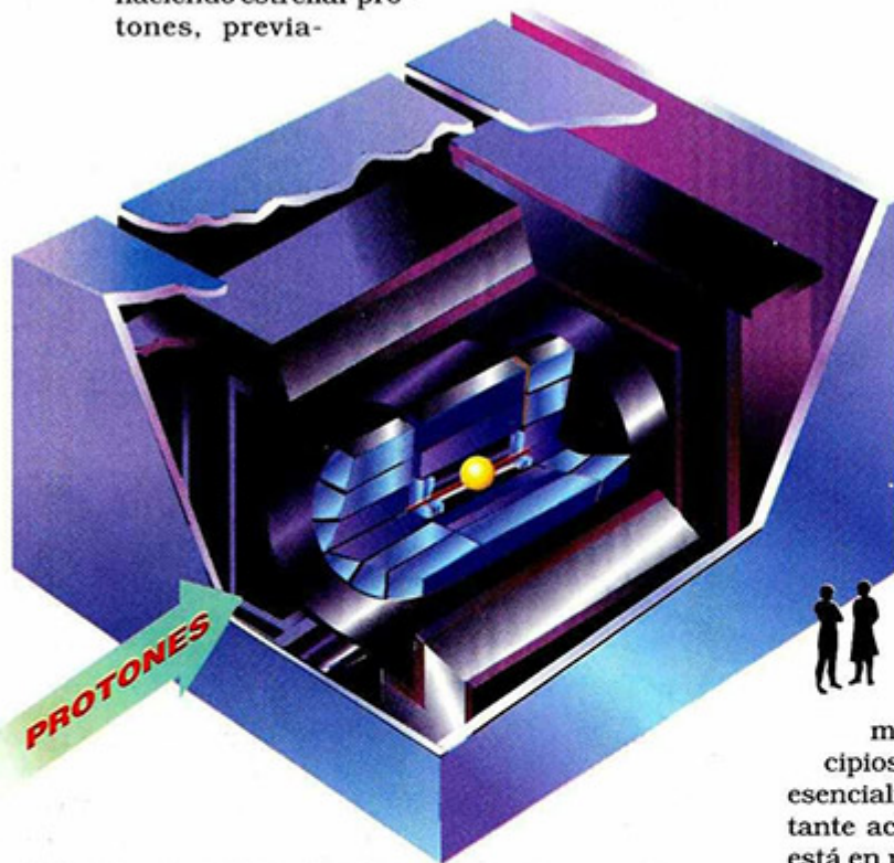
Figura 2: Vista del detector D 0 en Fermilab, con un corte que permite observar el interior. Los protones entran por un extremo y los antiprotones por el otro, de tal manera que la colisión ocurre en el centro del detector, indicado por el círculo amarillo. El detector pesa aproximadamente 5.000 toneladas, mide 12 metros de alto y los sistemas electrónicos que registran y almacenan la información producida por él ocupan un pequeño edificio de tres pisos de altura.
