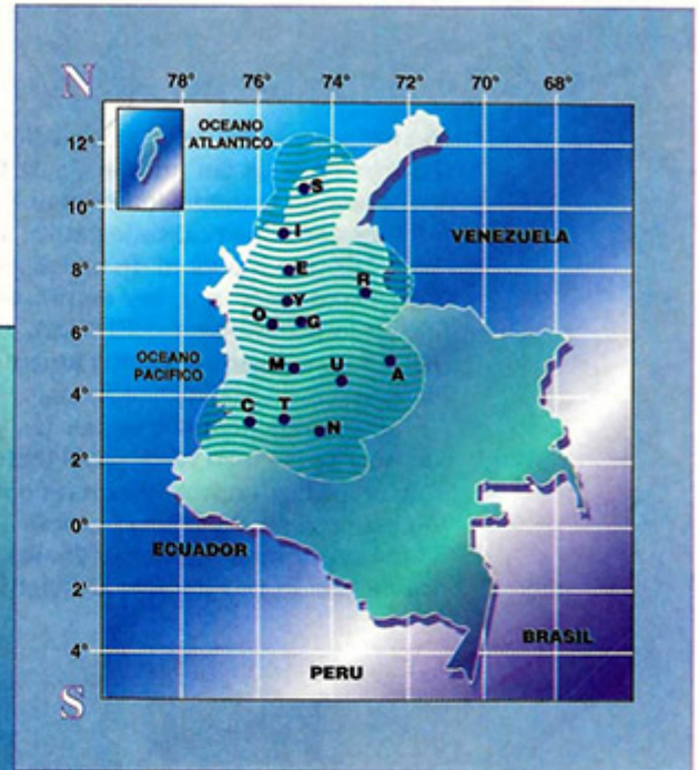
Figura 5. A: Localización y rango de cubrimiento de los sensores de la Red Colombiana de Medidores de Rayos Recma (U: Bogotá, O: Boquerón, G: Guatapé, Y: Yarumal, C: Cali, M: Manizales, R: Bucaramanga, S: Sabanalarga, I: Chinú, A: Guavio, N: Betania, T: Tuluá, E: Cerromatoso). B: Esquema de transmisión de datos, Red Colombiana de Medidores de Rayos Recma. (ECD: equipo de comunicación de datos, AP: analizador de posición).
