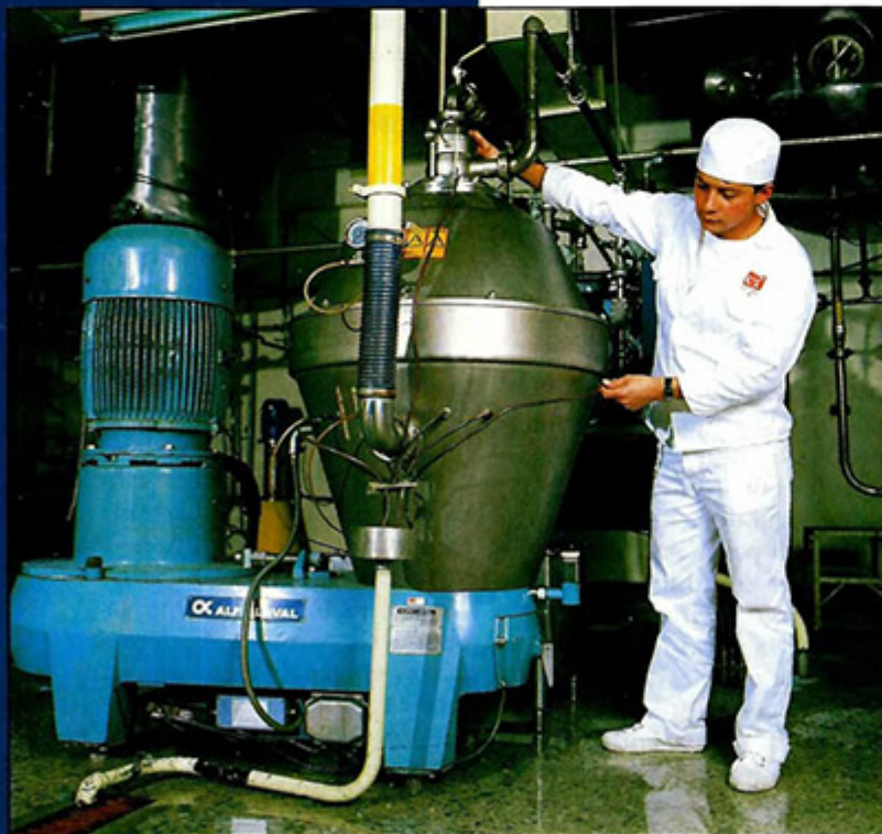
Figura 3. Centrifuga para procesos de purificación de la vacuna antiaftosa.
