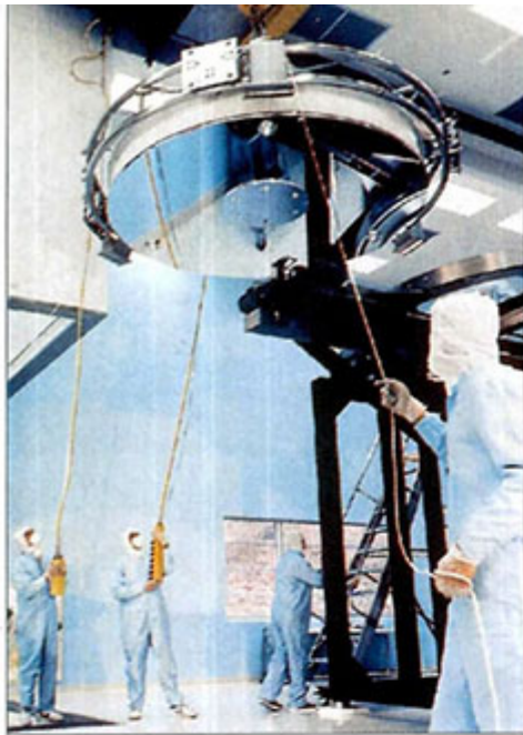
Figura 1. Proceso inicial de fabricación del telescopio espacial Hubble, donde se observa el espejo central de 2.4 metros de diámetro.
